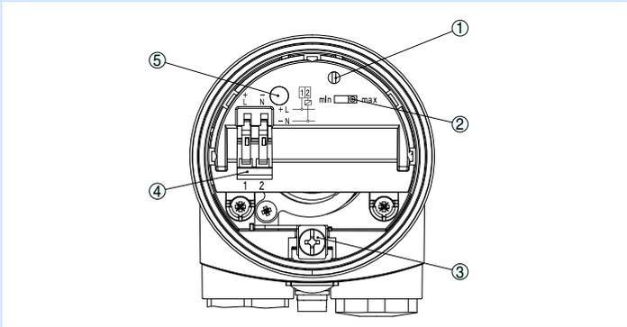
Отсек электроники и подключения - бесконтактный переключатель
